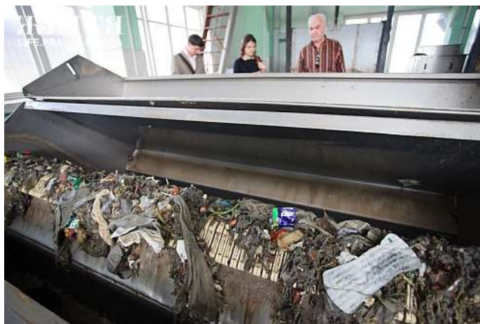
Рис. 1.2 – Приклад апарату для 1 етапу механічного очищення - габаритного сміття (грабельні решітки з отворами 16 мм)
