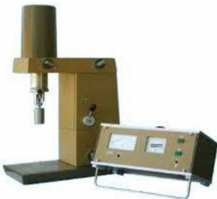
Рисунок 2.1 Ротаційний віскозиметр «Rheotest - 2» типу RV (Німеччина)
