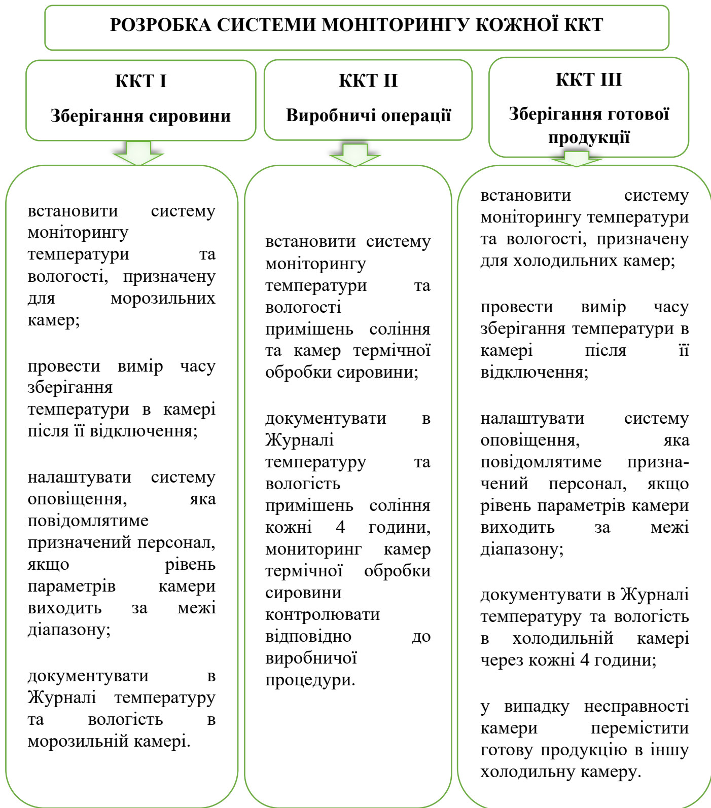
Рис. 2.4 Система моніторингу ККТ для системи НАССР ТОВ «Дари океану»
