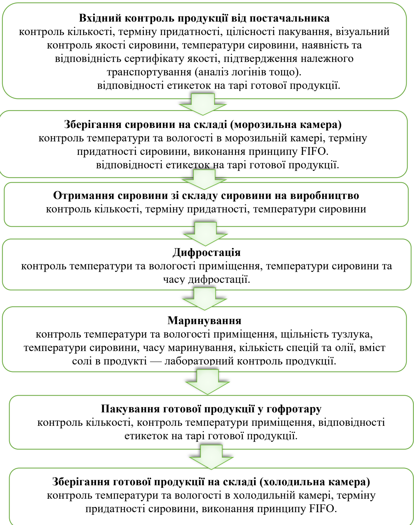
Рис.2.3 Блок-схеми технологічного процесу на виробництва пресервів
