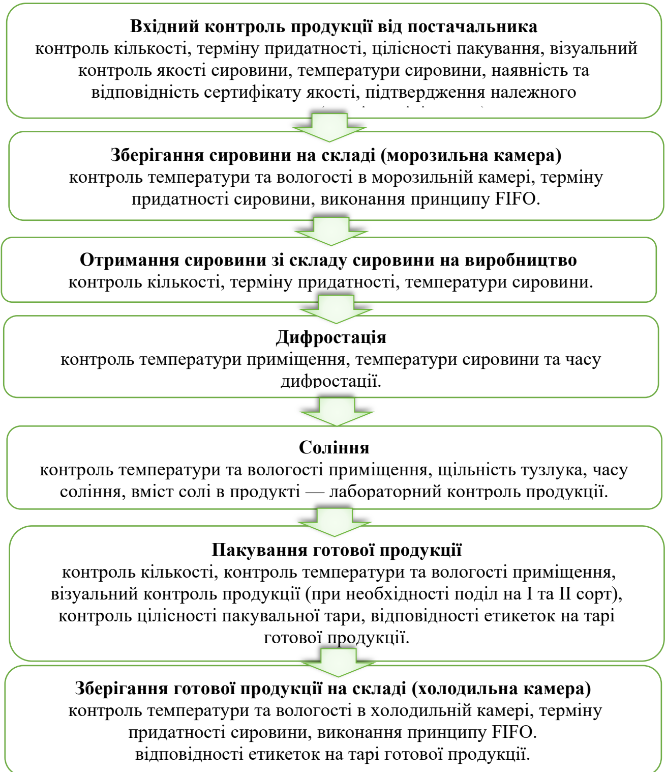
Рис. 2.1. Блок схема технологічного процесу виробництва риби соленої
