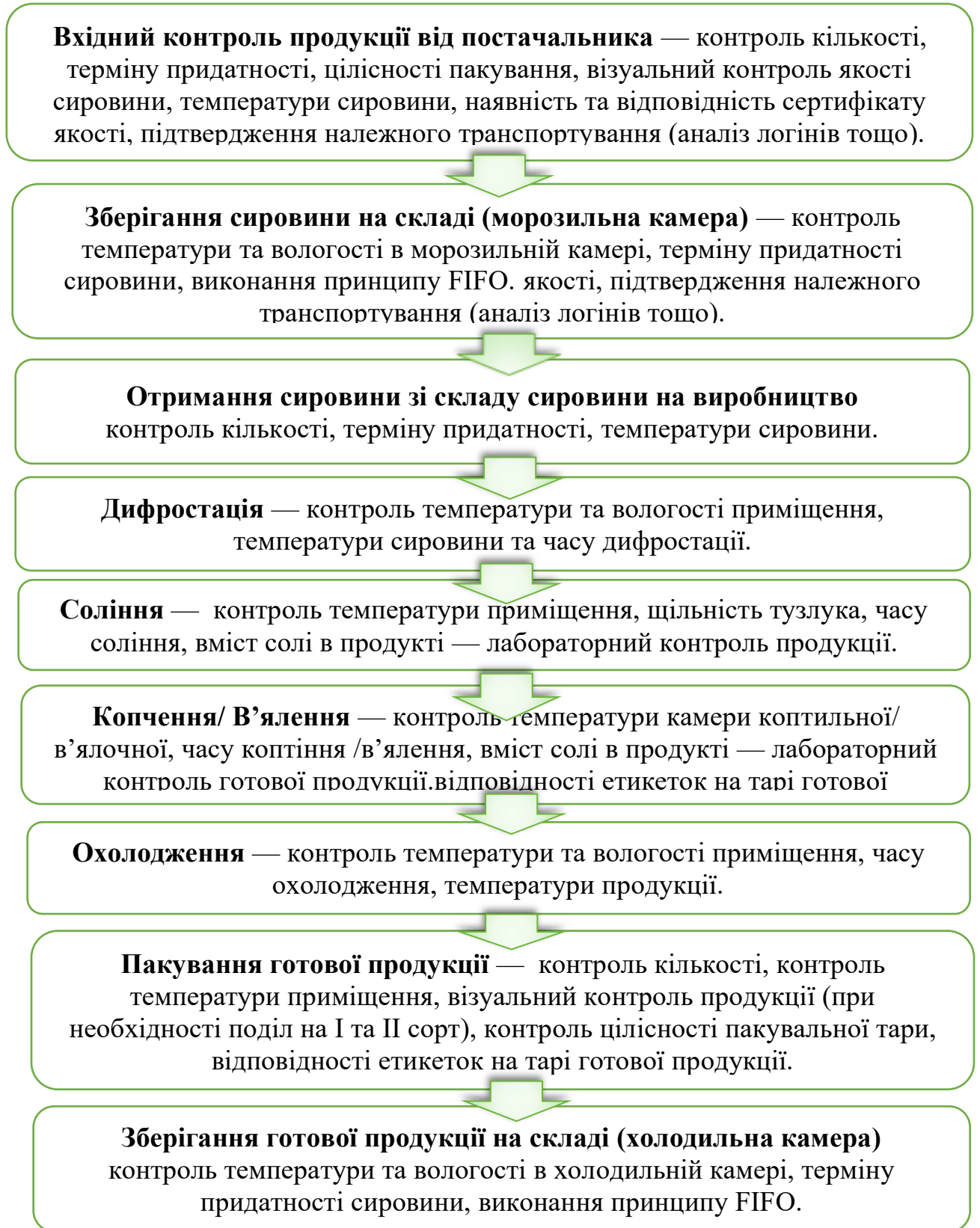
Рис. 2.2. Блок схема технологічного процесу виробництва риби копченої та в'яленої
