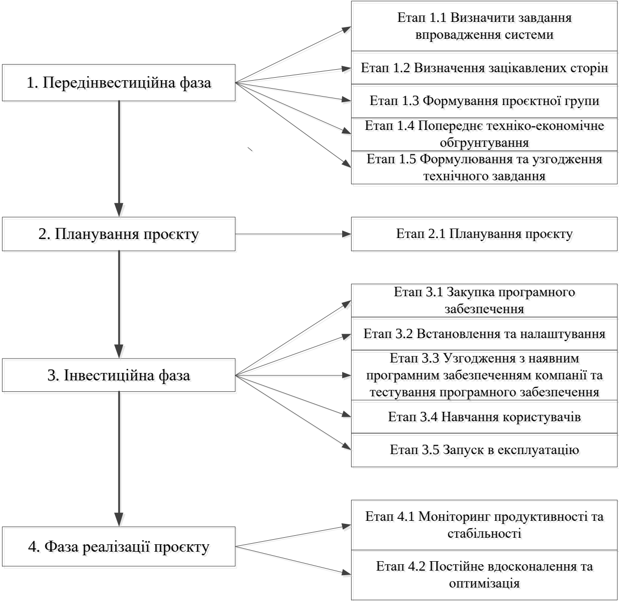
Рис. 3.4 Схема впровадження автоматизованої системи управління складом в ТЗОВ «ЗАХІДНА ФАРМАЦЕВТИЧНА КОМПАНІЯ»
