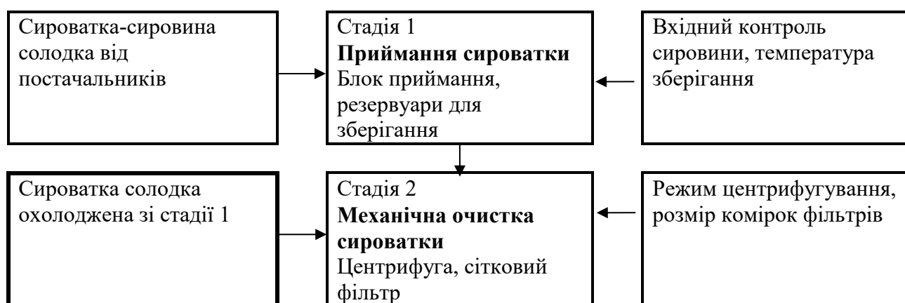
Рис. 3.1. Технологічна схема виробництва концентрату сироваткових білків у формі порошку.
