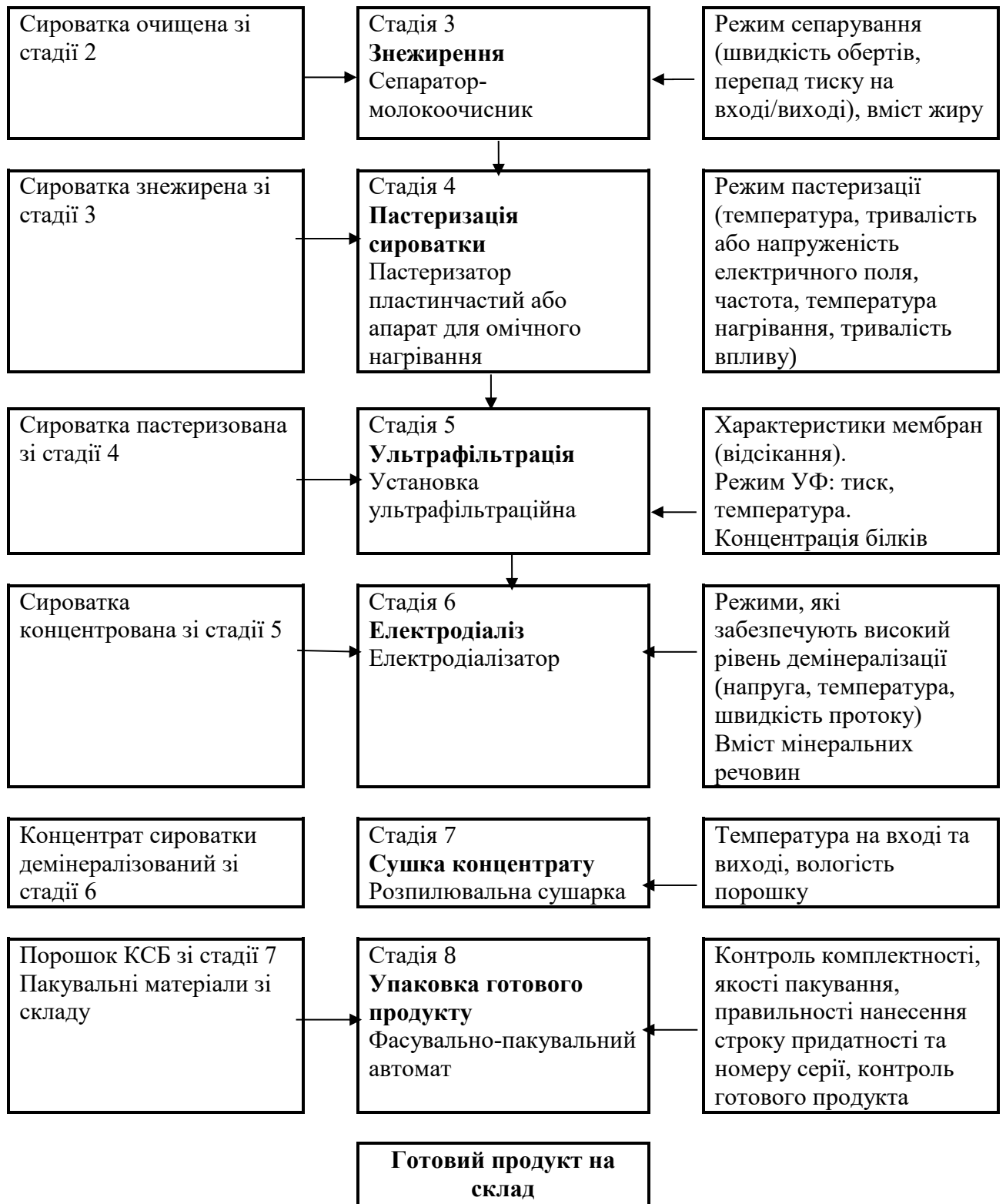
Продовження рис. 3.1. Технологічна схема виробництва концентрату сироваткових білків у формі порошку.
