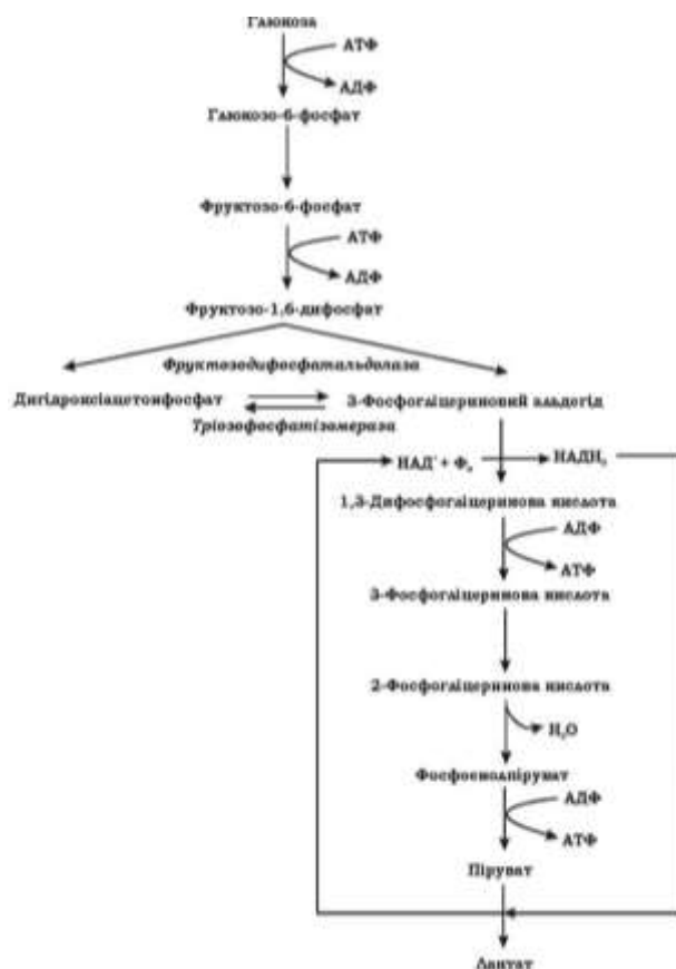
Рис. 2.1 – Схема гомоферментативного молочнокислого бродіння
