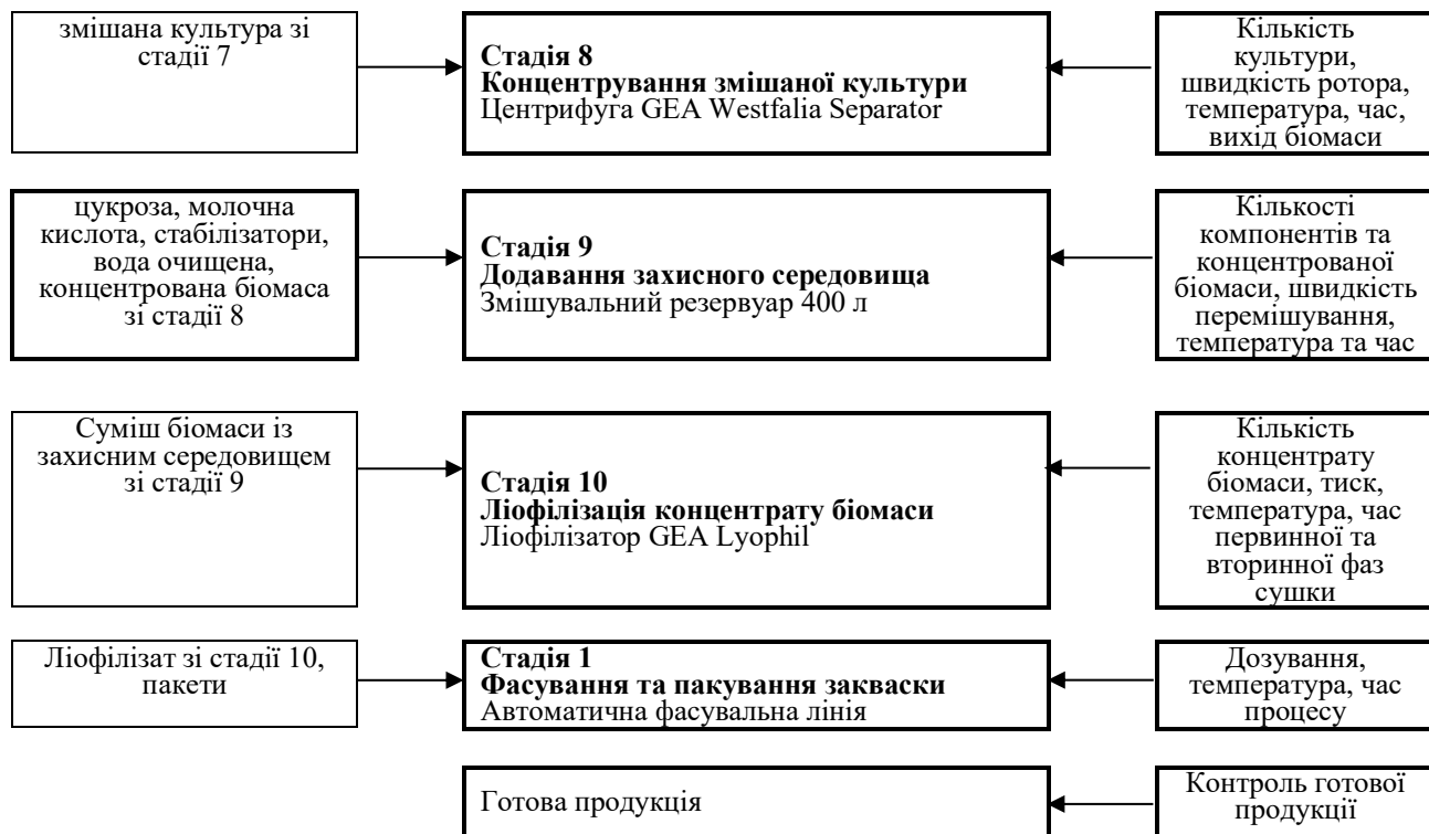
Рис. 3.2 – Технологічна схема виробництва бактеріальної закваски для твердих сирів
