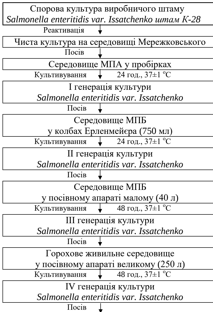
Рис 3.2 – Біологічна схема виробництва препарату «Бактороденцид Ново» у пластикових пляшках по 1 кг.
