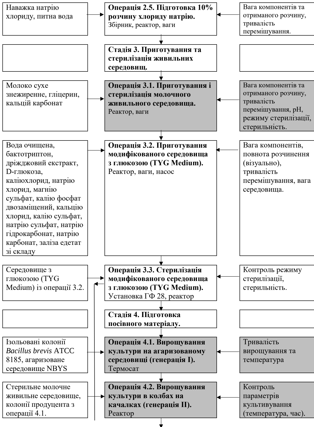
Продовження рис. 3.4 - Технологічна схема виробництва антибіотику «Граміцидин С, порошок-субстанція» по 1 кг.
