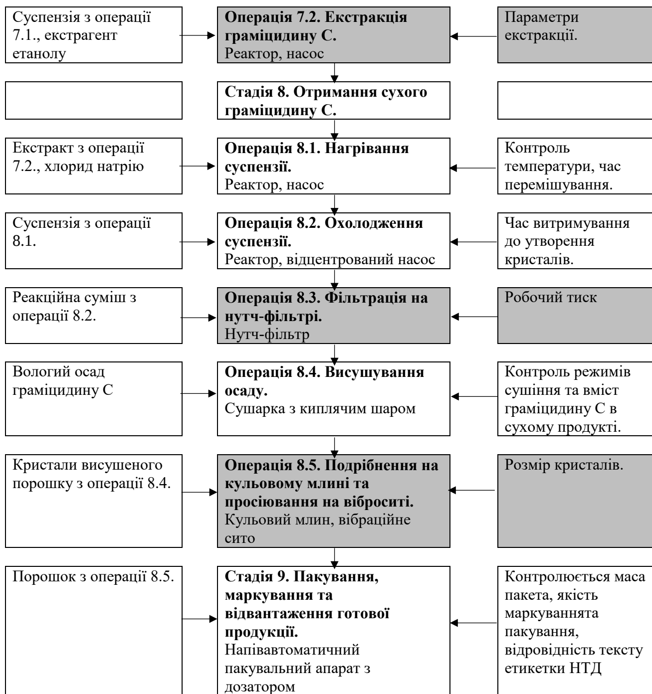
Продовження рис. 3.4 - Технологічна схема виробництва антибіотику «Граміцидин С, порошок-субстанція» по 1 кг.
