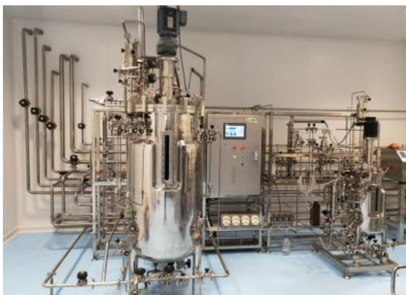
Рис. 3.2 – Загальний вид автоматичного ферментера ФА-200.[31]
