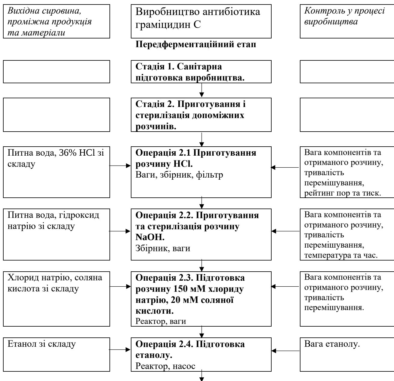
Рис. 3.4 - Технологічна схема виробництва антибіотику «Грамідин С, порошок-субстанція» по 1 кг
