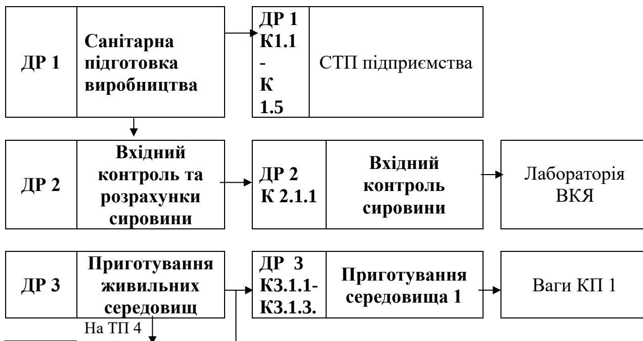
Рис. 3.2 - Технологічна схема виробництва закваски прямого внесення для ферментованих м'ясних продуктів «MeatCrafter» у пакетах по 25 г.
