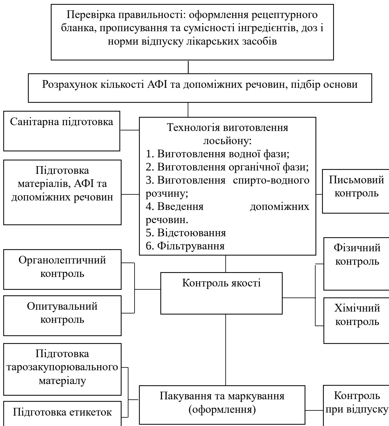
Рис. 3.3. Технологічна схема виробництва лосьйону в умовах аптеки
