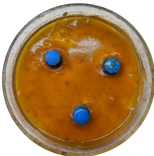
Рис. 3.5. Чашка Петрі з внесеним реактиву залізу III хлориду.
