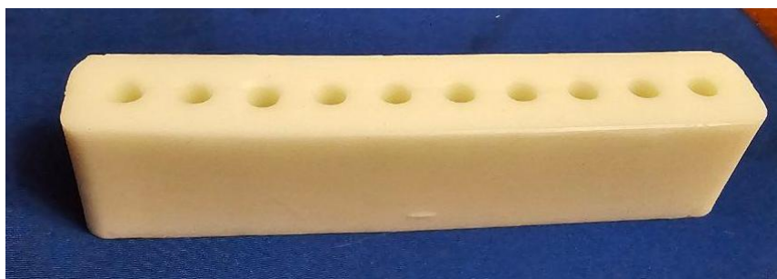
Рис. 3.2 Силіконова форма для виливання супозиторіїв багаторазового використання
