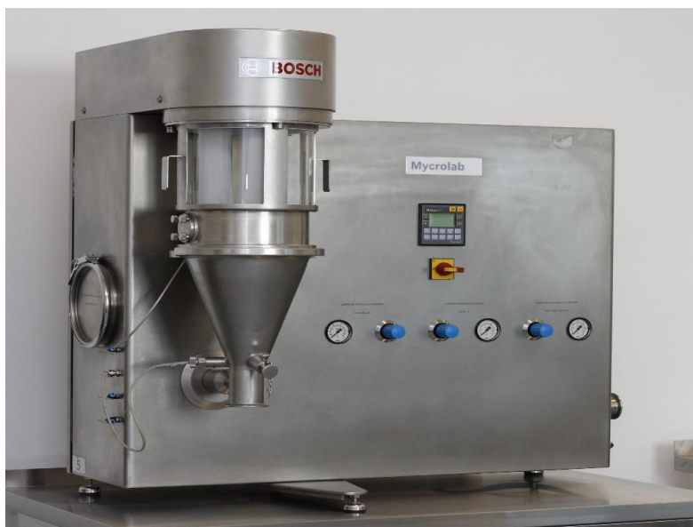
Рисунок 3.7. Установка для грануляції BOSCH «Mycrolab» (Німеччина).
