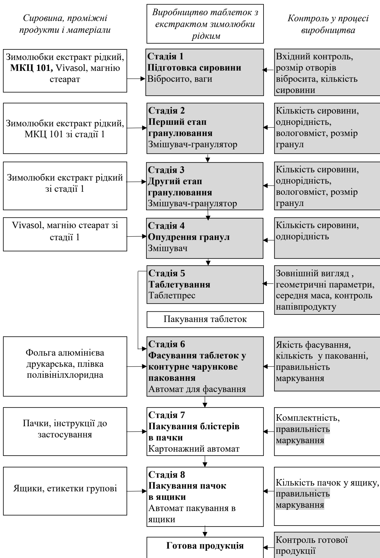
Рис. 4.24 Технологічна блок-схема виробництва таблеток
