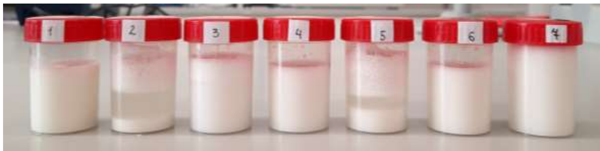
Рис. 3.11 Седиментаційна стійкість дослідних зразків із вмістом різних плівкоутворювачів
