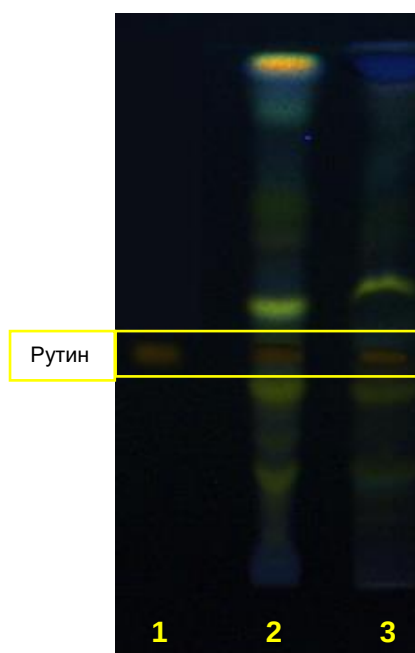
Рис. 5.1 Хроматограма випробуваного розчину гелю та розчину порівняння
