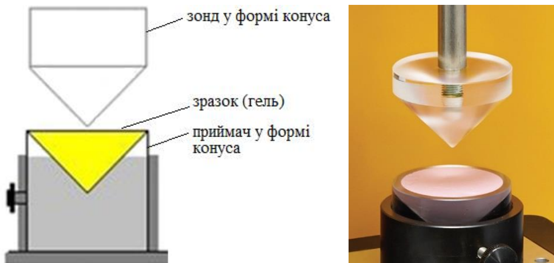
Рис. 2.4 Установка намазуваності на приладі TA.XT Plus
