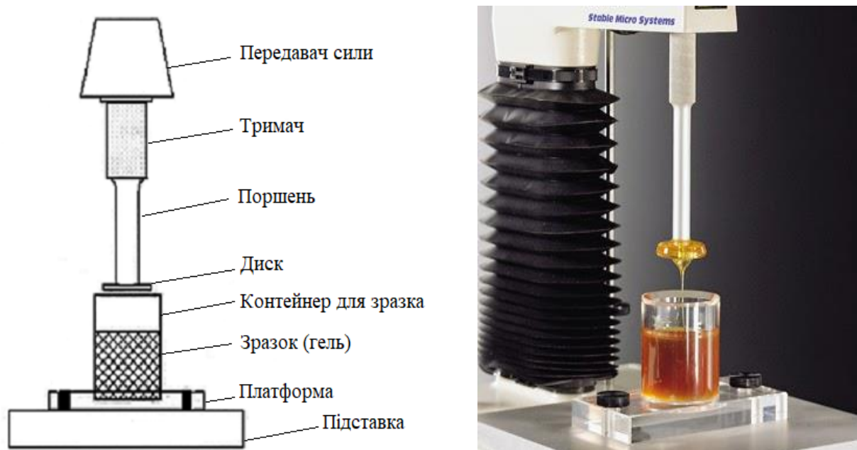
Рис. 2.2 Установка зворотної екструзії на приладі TA.XT Plus
