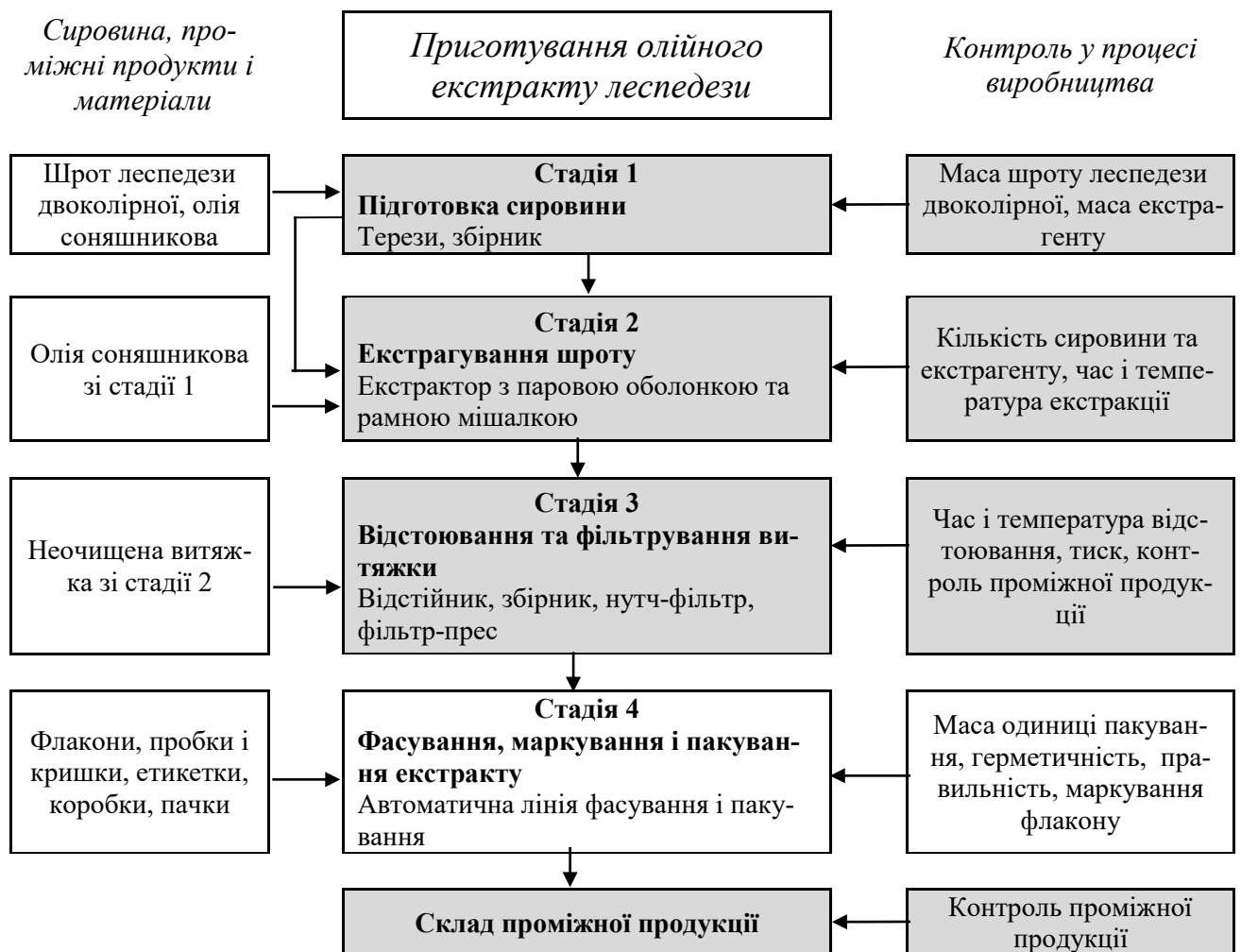
Рис. 3.14 Технологічна схема виробництва проміжного продукту – леспедези екстракту олійного
