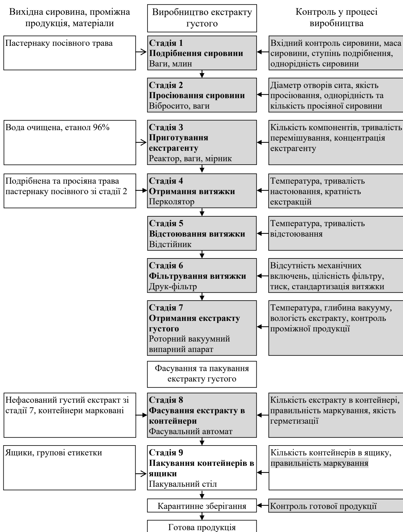
Рис. 4.1 Технологічна блок-схема виробництва рослинної субстанції ППТЕГ в промислових умовах
