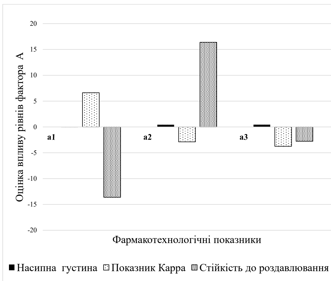
Рис. 3.15 Порівняльна оцінка впливу рівнів фактора А при вивченні густини до усадки, індексу Карра і стійкості до роздавлювання таблеток
