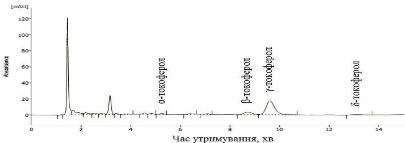
Рис. 3.21 Хроматограма, одержана при визначенні кількісного вмісту токоферолів у замороженому листі шпинату городнього методом ВЕРХ
