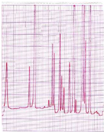
Рис. 4.20 Хроматограма, одержана при визначенні кількісного вмісту амінокислот у шпинату городнього листя екстракті густому методом іонообмінної рідинно-колонкової хроматографії
