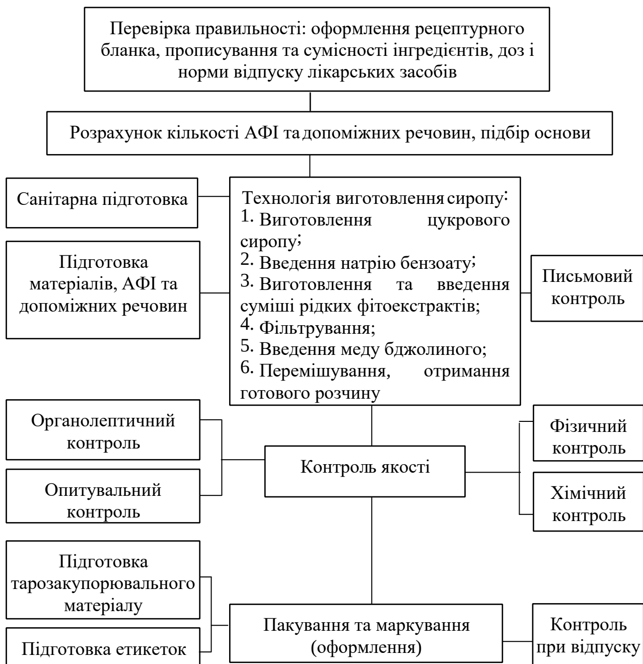
Рис. 3.1. Технологічна схема виготовлення фітосиропу в аптечних умовах
