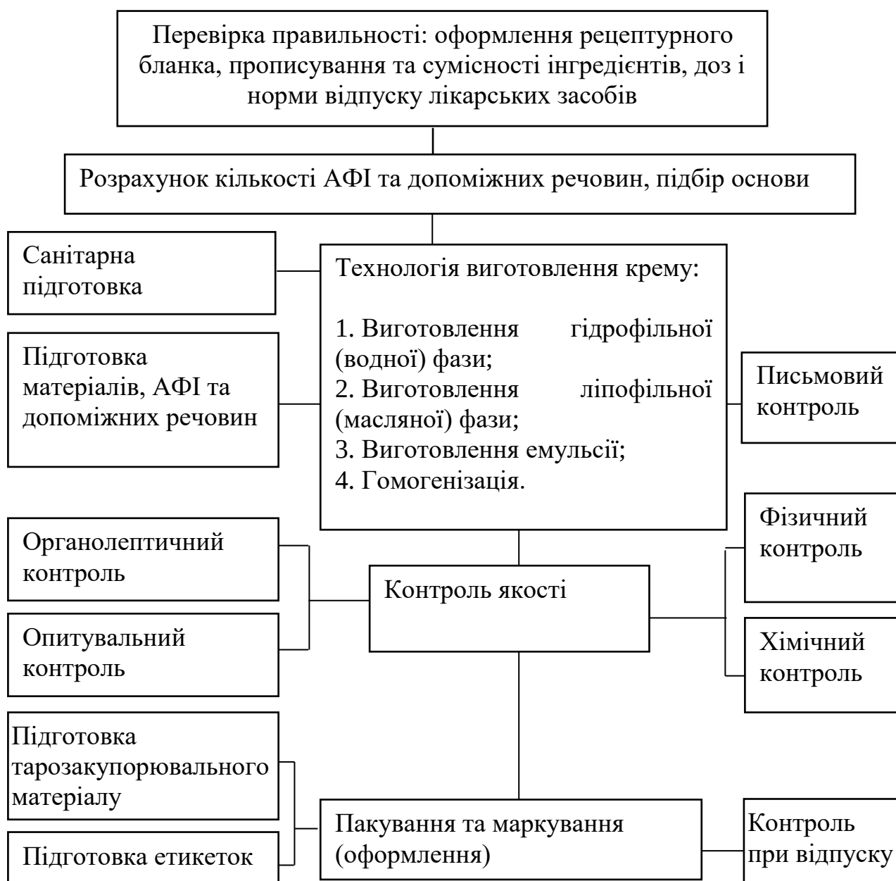
Рис. 3.3. Технологічна схема виробництва екстемпорального крему для лікування акне
