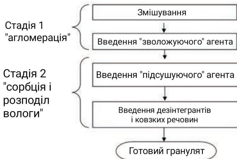
Рис. 3.8 Послідовність стадій грануляції
