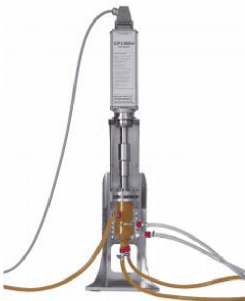
Рис. 2.2 Екстракція ультразвуком в лабораторних умовах
