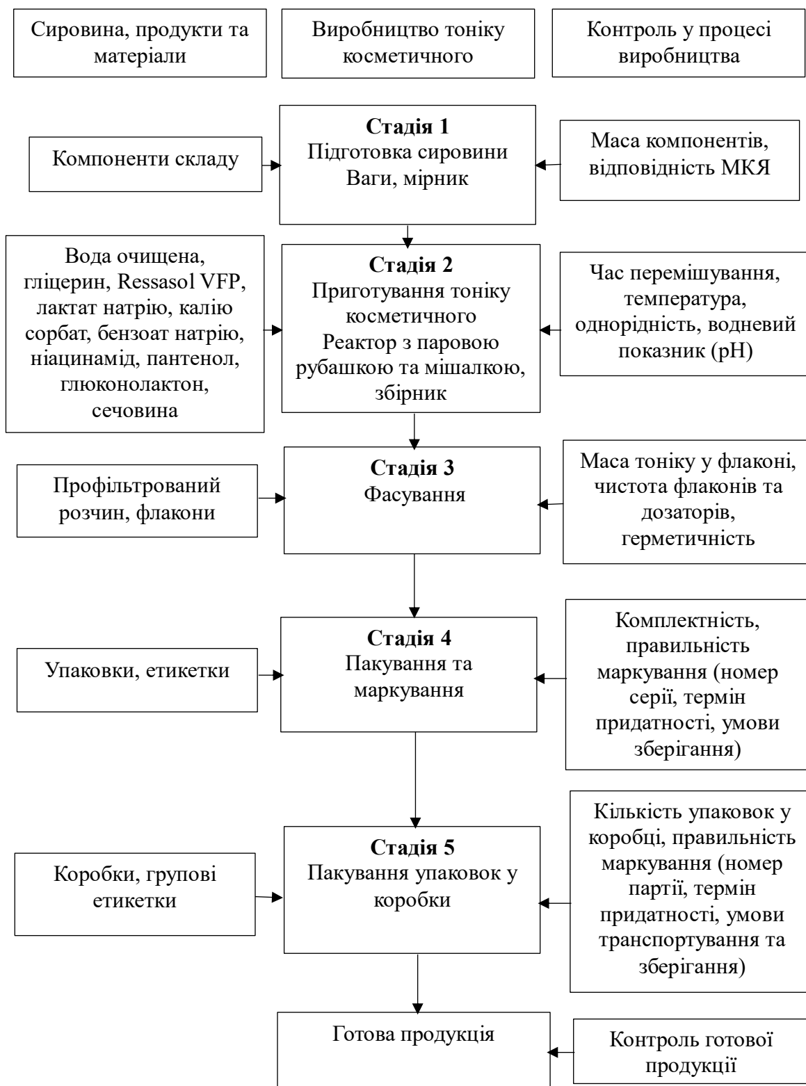
Рис. 3.1 Технологічна схема виробництва тоніку косметичного для профілактики фолікулярного кератозу
