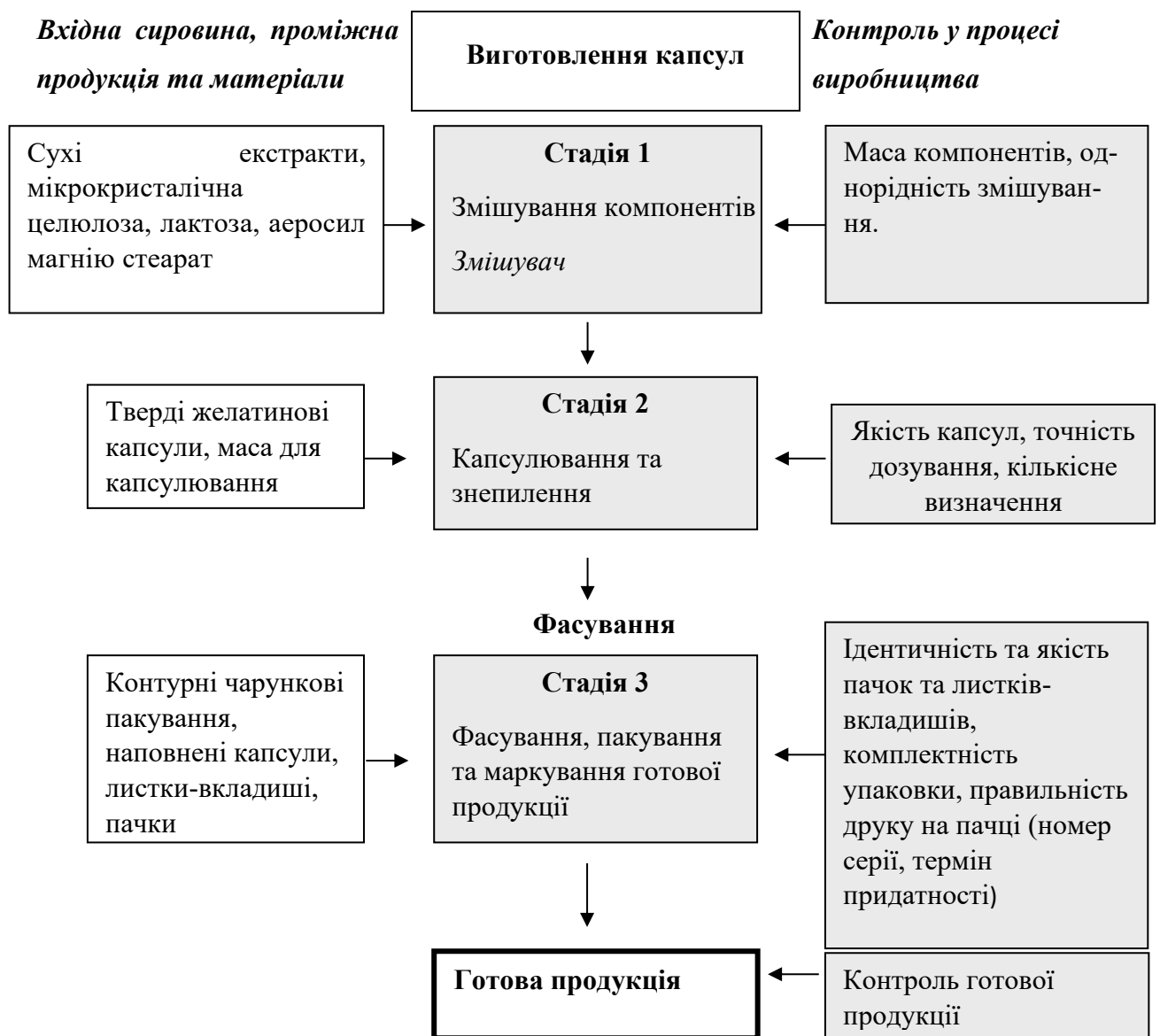
Рис. 3.4 Технологічна схема промислового виробництва капсул з сухими екстрактами берези, марени та хвощу
