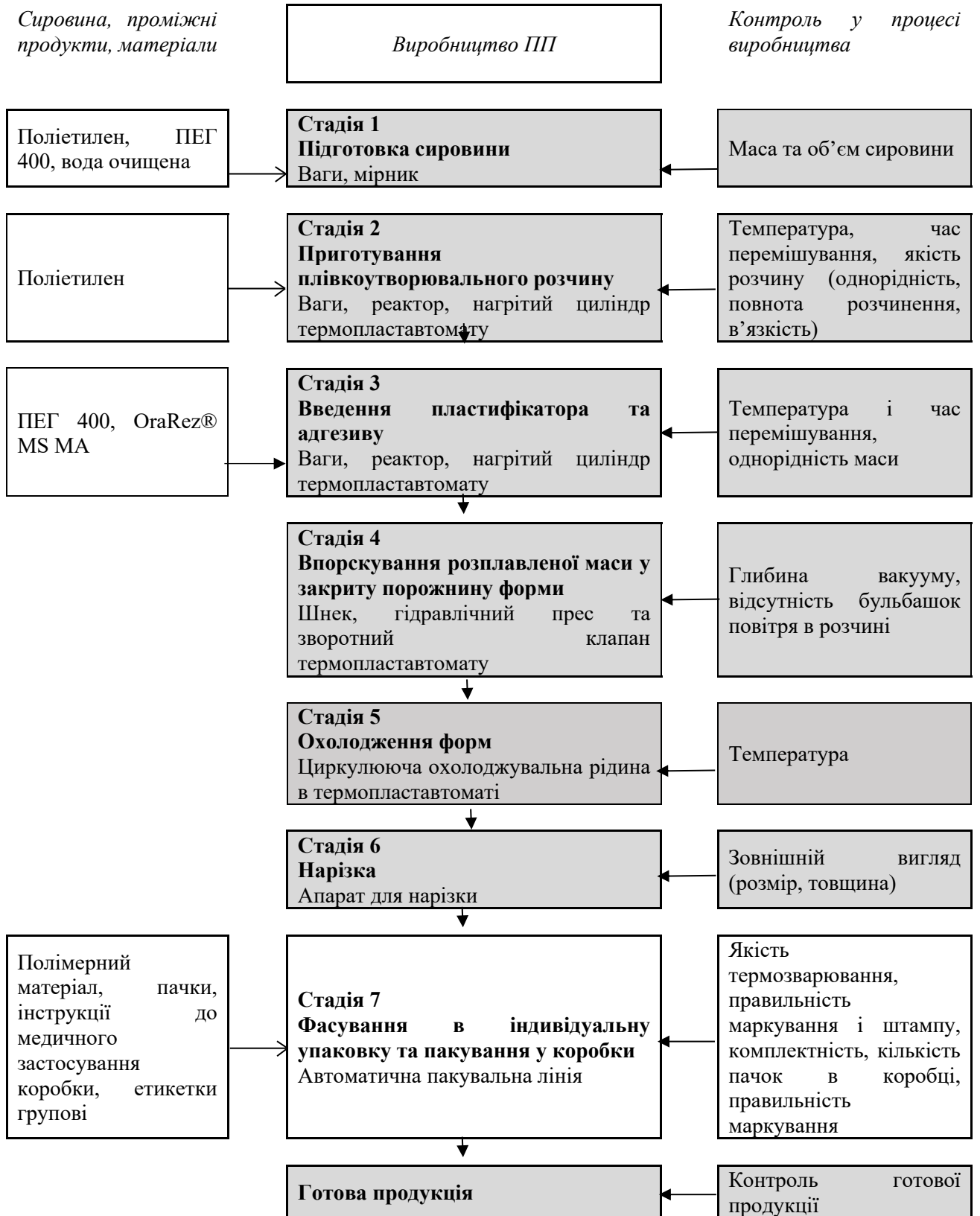
Рис. 3.2. Технологія промислового одержання плівок методом лиття під пресом
