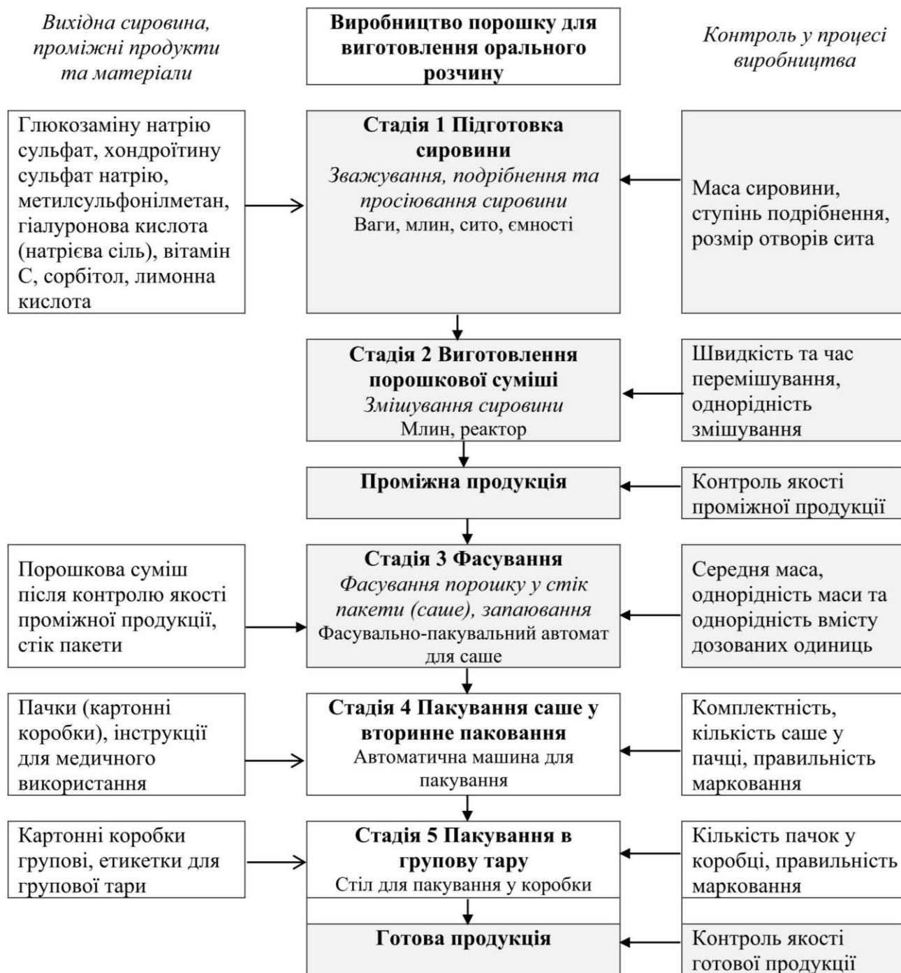
Рис. 3.8 Технологічна блок-схема виробництва порошку в саше пакеті для виготовлення орального розчину
