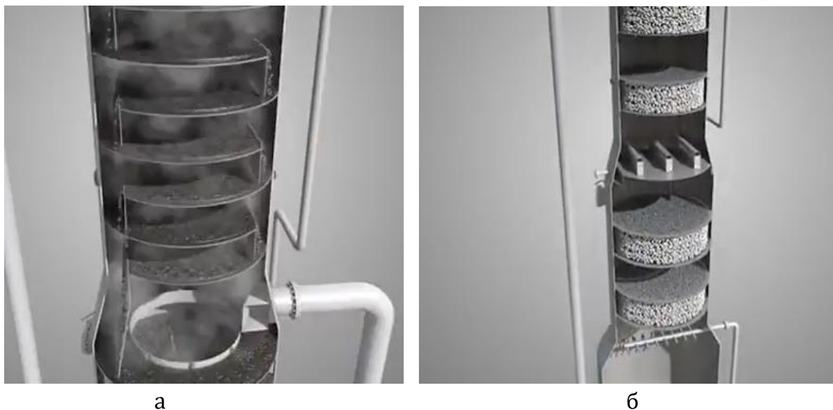
Рис. 19.6. Ректифікаційні апарати: а) тарілчасті; б) насадкові
