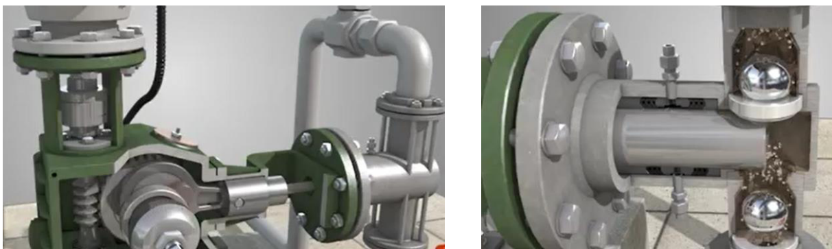
Рис. 4.3. Поршневий насос простої дії, загальний вигляд
