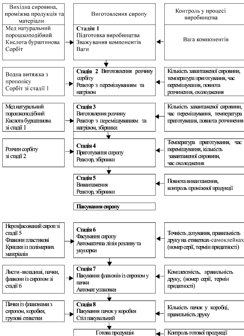
Рис. 2. Технологічна схема виробництва сиропу "Прополіс-ЛМ".
