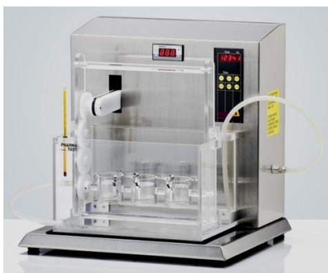
Рис. 1. Прибор для определения распадаемости ректальных и вагинальных суппозиториев (внешний вид тестера PTS 3E).
