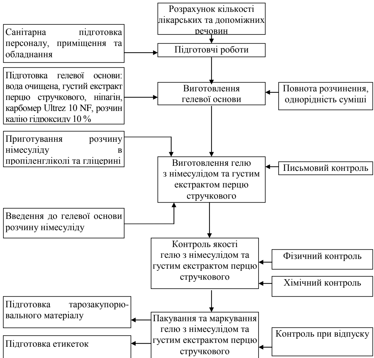
Рис. 1. Схема технології гелю з німесулідом та густим екстрактом стручкового перцю в умовах аптечного виробництва
